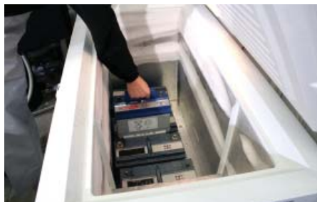
Préparation pour le test de courant à démarrage à froid.
